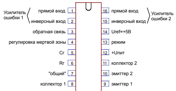
Рис. 11. Управляющая микросхема TL494 и ее цоколевка.
